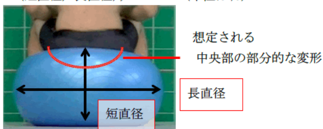
図6 扁平率算出に用いる短直径及び長直径
